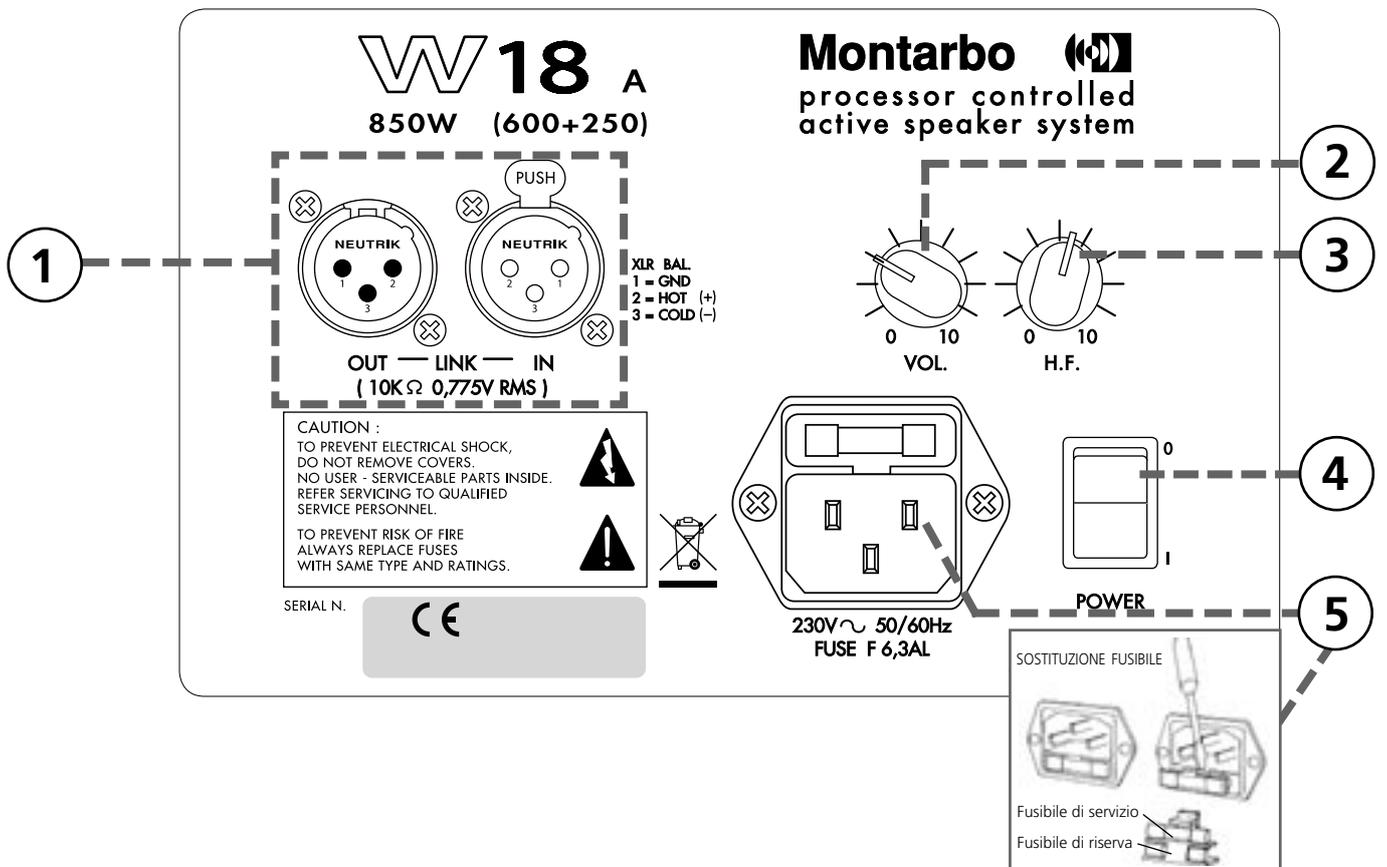
**1** Il sistema acustico W18A è dotato di prese XLR maschio (OUT) e femmina (IN) collegate in parallelo: ciò semplifica il collegamento di più sistemi.
