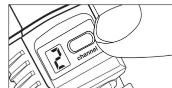
I canali di ricevitore e trasmettitore devono corrispondere.
